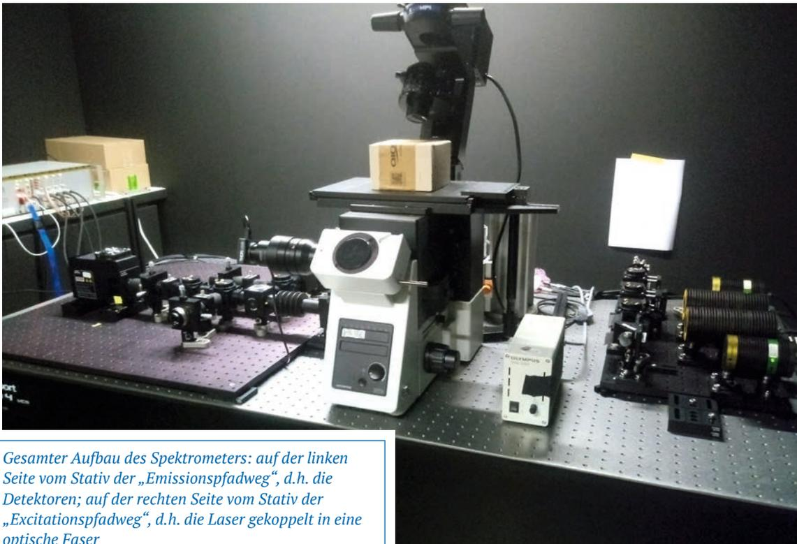
*Gesamter Aufbau des Spektrometers: auf der linken Seite vom Stativ der „Emissionspfadweg“, d.h. die Detektoren; auf der rechten Seite vom Stativ der „Excitationspfadweg“, d.h. die Laser gekoppelt in eine optische Faser*
