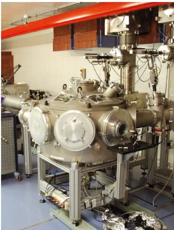
Abb. 3: Apparatur im Höchstfeldlaserlabor des MBI zur lasergetriebenen Elektronenbeschleunigung im Plasma. Hintergrund: Strahlungsschirmung, eingebautes Spektrometer und Kammer zur Laser-Plasma-Wechselwirkung. Vordergrund: Kammer zur Laserstrahlführung und Fokussierung.
