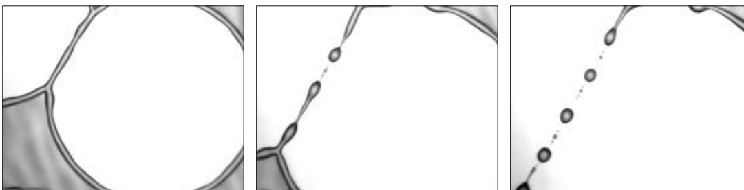
Aufbrechen der Stege und Satellitentropfenbildung im Experiment. Rims rupturing and forming satellite droplets in the experiment.
