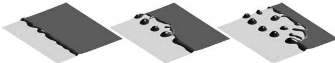
Simulation einer entnetzenden Flüssigkeit mit Tropfenbildung mit Schlupf-Parameter. Simulation of a dewetted liquid showing droplet formation with a specific slippage parameter.
