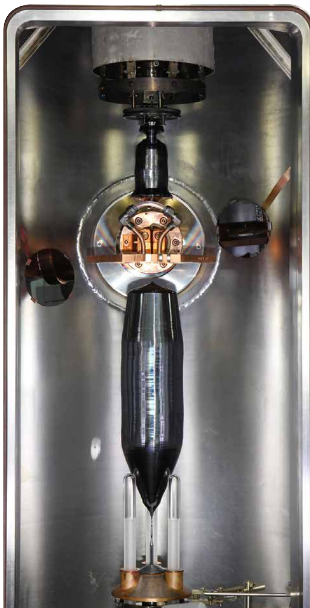
Im Kontext des KILOGRAMM-Projekts in einer Floating Zone Anlage gezüchteter Prototyp eines Silizium-28 Einkristalls (Quelle: IKZ)
